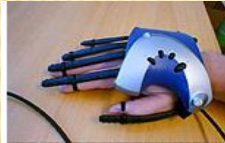
Manipulation d'objet Gant avec retour tactile ou retour d'effort
