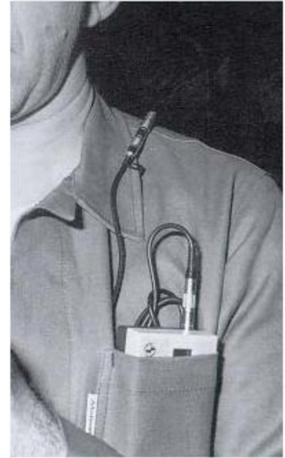
Exposimètre et son micro en position de mesure
