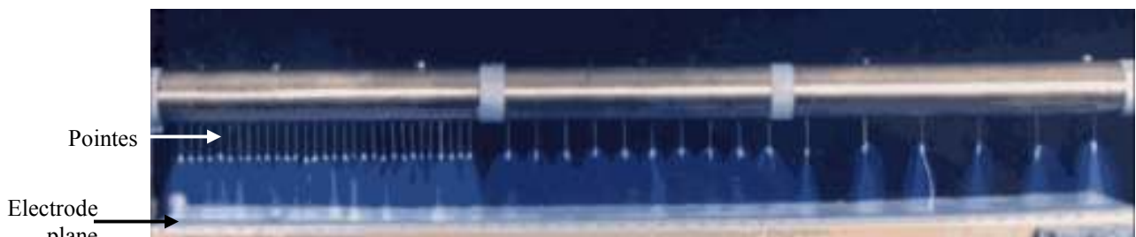
Décharge couronne lumineuse produite entre des pointes et une électrode plane reliée à la terre
